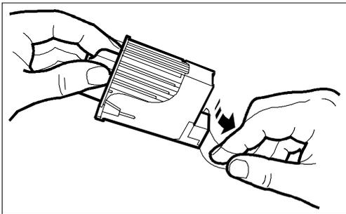
**Ne touchez ni les buses ni les contacts électriques**, et, si la tête est dotée d'une cartouche interchangeable, **ne retirez pas** la cartouche d'encre de la tête d'impression.
