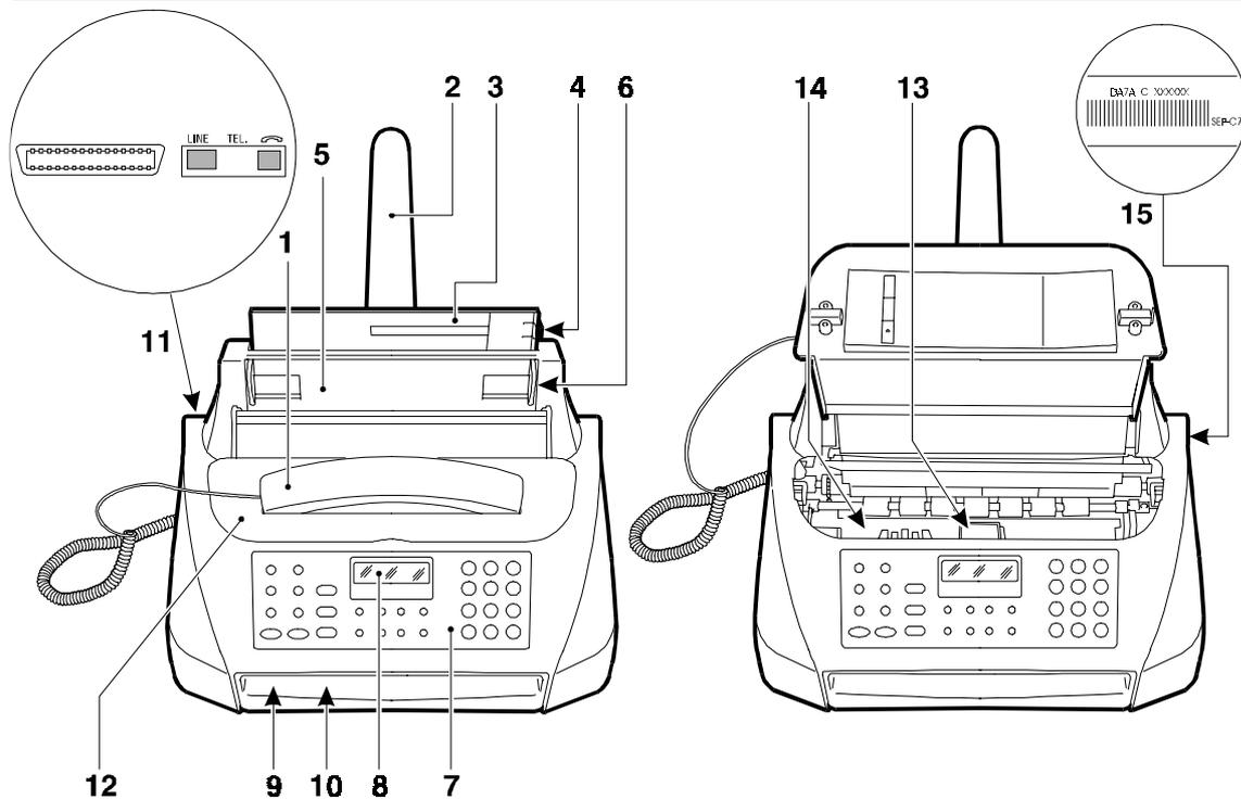
Les figures illustrent les composants externes **communs aux trois modèles de fax**, à l'exception de la **seconde rangée de touches** (sur la gauche du tableau de bord) présente uniquement sur le **modèle avec répondeur automatique incorporé**, et de l'**interface parallèle** présente uniquement sur le **modèle multifonctionnel**.
