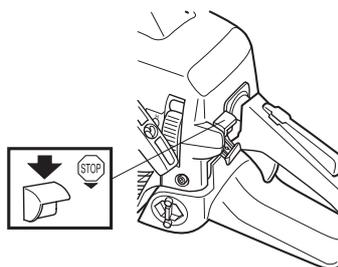
Le moteur est arrêté en poussant l'interrupteur d'arrêt en position d'arrêt.
