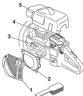
Nettoyer le système de refroidissement avec une brosse une fois par semaine, voire plus souvent dans des conditions difficiles. Un système de refroidissement sale ou colmaté provoque la surchauffe de la machine, endommageant le cylindre et le piston.
