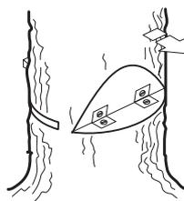
Le contrôle de la direction de chute de l'arbre fonctionne mal si la charnière est trop petite ou coupée trop profondément ou si les deux entailles ne coïncident pas.
