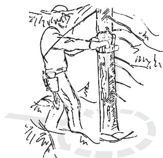
Dégager les taillis autour du tronc et éviter les obstacles tels que pierres, branches cassées, fondrières, etc. pour s'assurer d'une voie de retraite facile au moment de la chute. La voie de retraite doit être à 135° derrière le sens de chute prévu de l'arbre.
