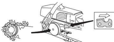
S'assurer que la face tranchante des dents est vers l'avant sur le dessus du guide.
