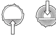
**Les deux extrémités du tronc reposent sur des supports.** Risque important de coinçage de la chaîne.
