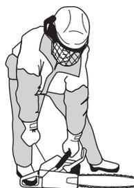
Enfoncer la commande du starter dès que le moteur s'allume et répéter les lancements jusqu'au démarrage. Quand le moteur démarre, accélérer rapidement à fond, ce qui en même temps supprime le ralenti accéléré.
