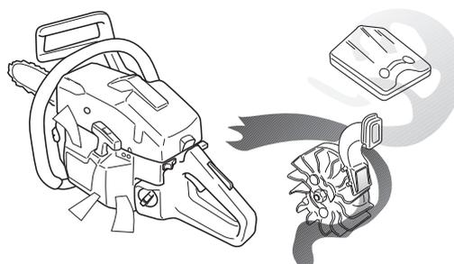
**IMPORTANT!** L'épuration centrifuge exige un entretien correct et continu de la machine. Nettoyer la prise d'air du lanceur, les ailettes du ventilateur, le compartiment du volant, le tuyau d'admission et le compartiment du carburateur.
