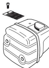
Le silencieux est conçu pour atténuer le bruit et dévier le flux des gaz d'échappement loin de l'utilisateur. Ces gaz sont chauds et peuvent transporter des étincelles risquant de causer un incendie si elles entrent en contact avec un matériau sec et inflammable.
