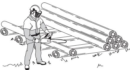
**Le tronc est couché à même le sol.** Il n'y a aucun risque de coinçage de la chaîne ou de fendage de la pièce à scier. Par contre, il existe un risque important que la chaîne rencontre le sol après le sciage.
