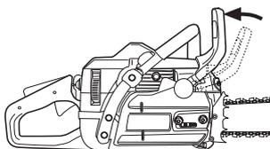
Déposer les écrous du guide-chaîne et le carter d'embrayage (frein de chaîne). Déposer la protection de transport (A).
