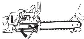
La tension d'une chaîne neuve doit être vérifiée fréquemment pendant son rodage. Vérifier régulièrement la tension. Une tension correcte est synonyme de bonne capacité de coupe et de longue durée de vie.
