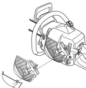
Ces dispositifs permettent de réduire la quantité d'air froid admise et empêchent que de grandes quantités de neige soient aspirées dans le compartiment du carburateur.
