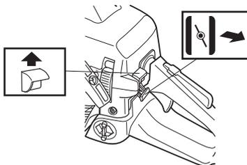
Si la machine est équipée d'un décompresseur (A): enfoncer celui-ci pour réduire la pression dans le cylindre et faciliter le démarrage de la machine. Toujours utiliser le décompresseur au démarrage. Une fois le moteur lancé, le décompresseur se remet automatiquement en position initiale.
