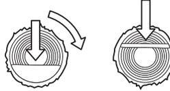
**Une extrémité du tronc repose sur un support.** Risque important de fendage.
