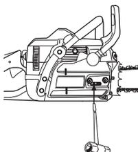
La chaîne est tendue correctement quand elle ne pend plus sous le guide et peut être avancée à la main sans difficulté. Serrer les écrous du guide à l'aide de la clé universelle tout en maintenant levé le pignon du guide.
