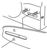
Tendre la chaîne en tournant la vis du tendeur de chaîne vers la droite à l'aide de la clé universelle. Tendre la chaîne jusqu'à ce qu'elle ne pende plus sous le guide.
