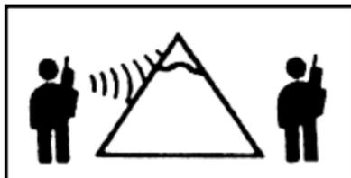
Une portée optimale se rencontre dans les zones plates, ouvertes, s'étendant jusqu'à 3 kilomètres. Une plage moyenne est rencontrée lorsque des bâtiments et des arbres bloquent la transmission. La plage est minimale, lorsque des feuillages et des montagnes bloquent le chemin de communication.
