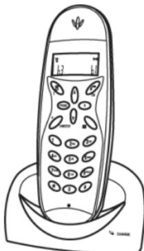
Cet appareil est équipé d'un clavier étanche, pouvant être essuyé. N'utilisez qu'un chiffon humide propre, sans détergent, ni produit chimique. Les touches téléphoniques ont les mêmes fonctions que celles du téléphone de salon.
