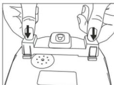
Placez les pattes du support au dos de l'appareil et appuyez fermement pour clipser les pieds du support.
