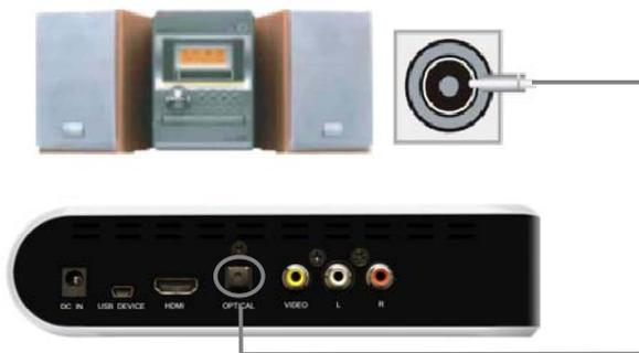
Branchez une extrémité du câble optique dans l'appareil et l'autre extrémité du câble dans votre appareil audio.
