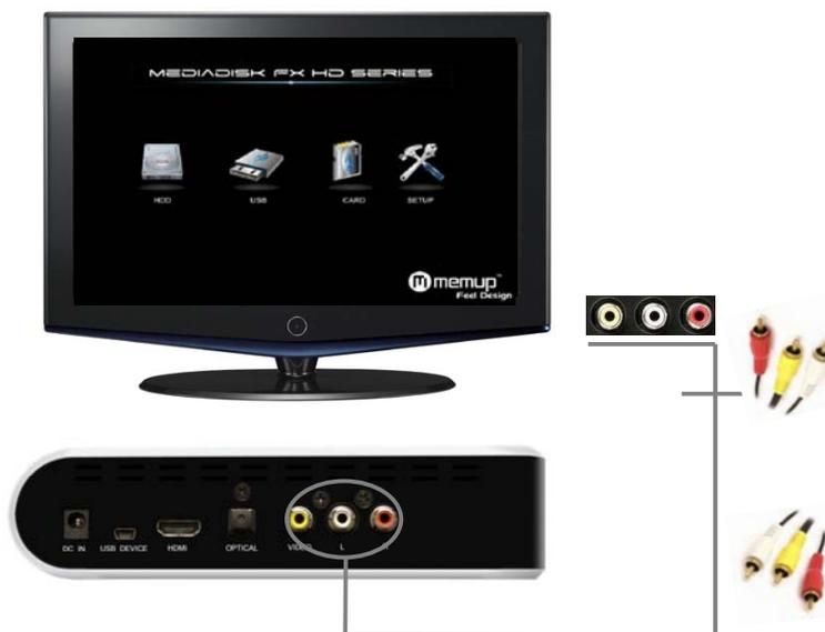
Branchez une extrémité du câble jaune dans la prise de sortie AV de l'appareil et l'autre extrémité dans la prise d'entrée AV de votre téléviseur.
