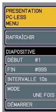
Pour l'initialiser, appuyez sur **ENTER** sur la télécommande ou la télécommande Web, ou **IINPUT/ENTER** sur le projecteur.
