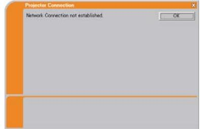
**REMARQUE** • Si vous avez sélectionné Ma Connexion, "Live Viewer 3" est fermé. Vérifiez les Network Settings (Paramètres Réseau) du projecteur et réessayez de vous connecter depuis la rubrique **3.3 Connexion Rapide au réseau.** (
