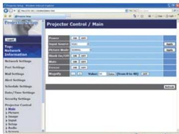
Les éléments du tableau ci-dessous peuvent être sélectionnés à partir du menu Projector Control . Sélectionnez un élément en utilisant les touches haut et bas de votre clavier.
