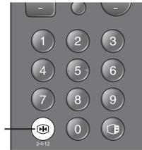
Il y a deux types de mode de gel d'image. Ils peuvent être choisis dans le "Mode gel d'image" du menu Fonction.
