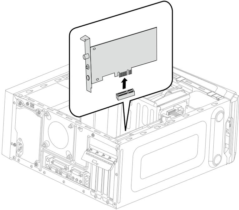
5. Installez la nouvelle carte de tuner TV sur le même connecteur et fixez-la sur le châssis à l'aide de la vis.
