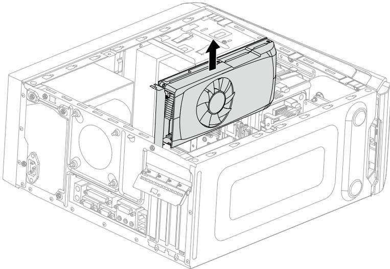
3. Installez le nouvel adaptateur sur le même connecteur et fixez-le sur le châssis à l'aide de la vis.
