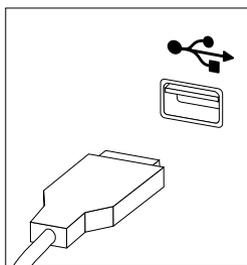
4. Débranchez le câble du clavier défectueux de l'ordinateur et raccordez le câble du nouveau clavier au même connecteur.
