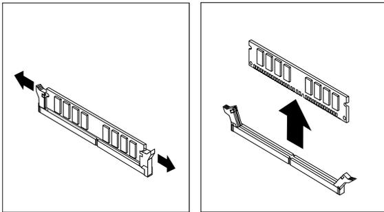
4. Placez le nouveau module de mémoire sur le connecteur de mémoire. Veillez à aligner l'encoche **1** du module de mémoire sur le repère du connecteur **2** sur la carte mère. Poussez le module de mémoire dans le connecteur jusqu'à ce que les clips de retenue se ferment.
