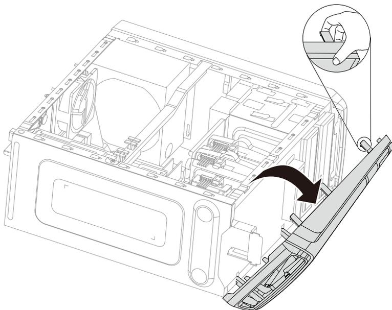
3. Pour remonter le cache, alignez les languettes en plastique sur l'arrière du cache en faisant correspondre les orifices dans le châssis, puis enclenchez-le pour le mettre en place.
