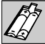
Placer les piles neuves dans le logement en respectant les polarités indiquées (+ et -).
