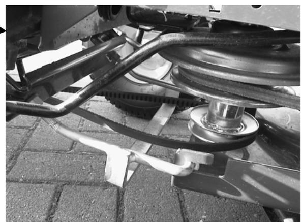
Veillez à ce que la courroie trapézoïdale passe autour de galet tendeur à la balayeuse comme représenté.
