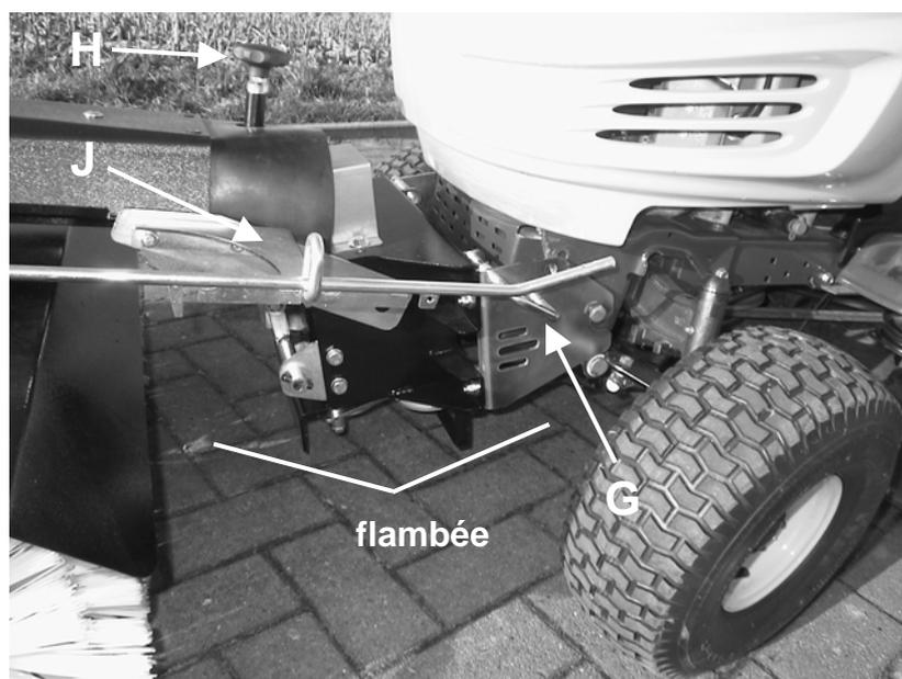
2. Placez le capot de la barre de coupe en position basse et retirez la courroie de la poulie additionnelle. Laissez-la simplement en bas.
