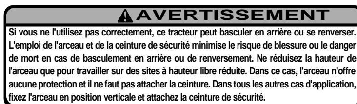
AUTOCOLLANT D'AVERTISSEMENT (BASCULEMENT / RENVERSEMENT) SITUÉ SUR L'AILE ARRIÈRE DROITE
