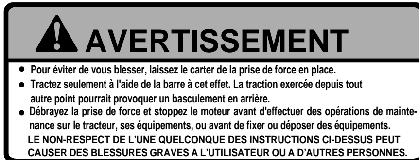
AUTOCOLLANT D'AVERTISSEMENT (PTO) SITUÉ SUR LE CAPOT ARRIERE DE LA PRISE DE FORCE
