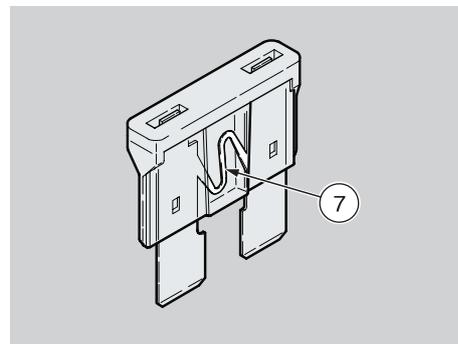
**Si l'on emploie le fusible de réserve (4) (5) (6), en insérer un identique dans le logement approprié.**
