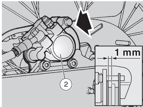
Pour effectuer un contrôle rapide de l'usure des plaquettes:
