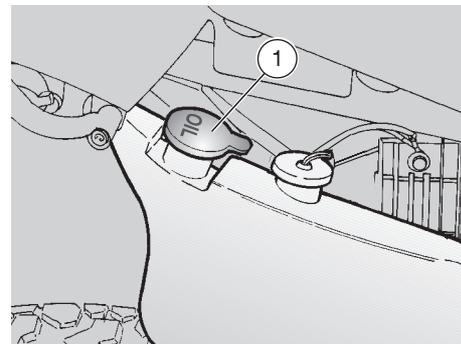
Pour introduire l'huile du mélangeur dans le réservoir il faut:
