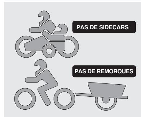
Ce véhicule n'a pas été conçu pour l'assemblage d'un side-car ou pour traîner de remorques ni d'autres véhicules.
