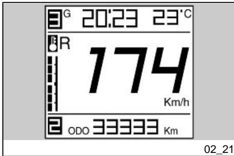
La modalité **RAIN** est conçue pour une utilisation de l'engin sur des surfaces mouillées ou avec une faible adhérence. Le système réduit le couple maximum délivré par le moteur et il le fournit doucement, pour éviter les pertes d'adhérence. Sur cette modalité, les performances de la moto sont réduites, donc il n'est pas possible d'atteindre la vitesse maximum.
