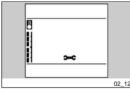
Lorsque la température extérieure est inférieure ou égale à 3 °C (37 °F), le symbole de l'alarme glace apparaît sur l'afficheur.
