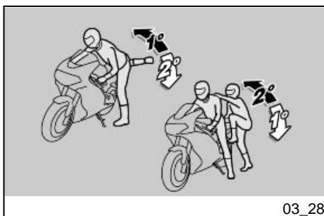
Monter et descendre seulement du côté gauche du véhicule et seulement avec la béquille latérale abaissée.
