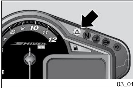
Ce véhicule est conçu pour identifier en temps réel d'éventuelles anomalies de fonctionnement, mémorisées par la centrale électronique.
