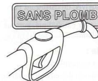
Sur les véhicules à moteur à essence, le diamètre du goulot de remplissage du réservoir est réduit et n'est compatible qu'avec les pistolets ravitailleurs d'essence sans plomb.
