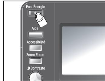
L'affichage de l'écran tactile réapparaît et, lorsque la machine a achevé son cycle de préchauffage, elle est de nouveau prête à fonctionner.
