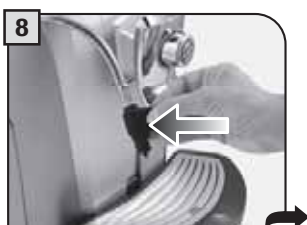
8 Estrarre e lavare il supporto del tubo vapore; dopo reinserire.
