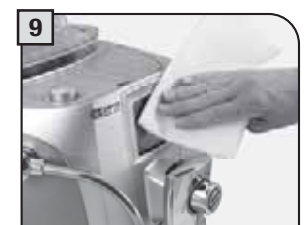
9 Oczyszczyć wyświetlacz suchą ściereczką.
