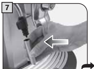
7 Estrarre la parte terminale del tubo vapore; dopo reinserire.
