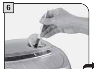
6 Oczyszczyć pędzelkiem pojemnik wstępnie mielonej kawy.
