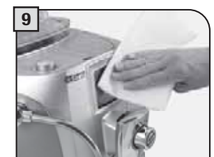
9 Nettoyer l'afficheur avec un chiffon sec.
