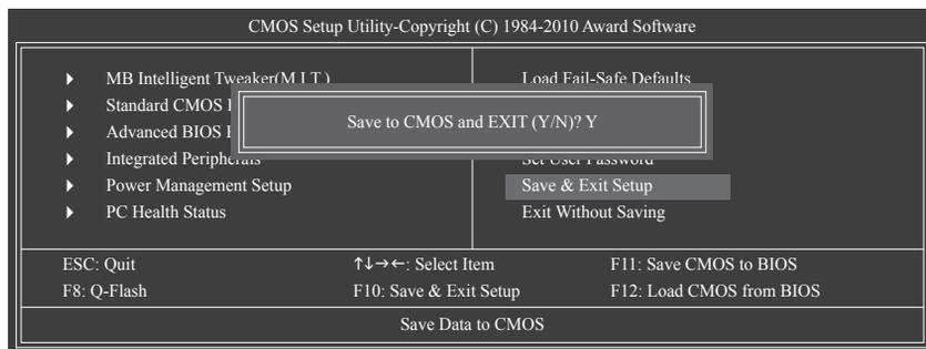
Appuyez sur <Enter> dans cet élément puis appuyez sur la touche <Y>. Cela sauvegardera les modifications dans le CMOS et quittera le programme de configuration du BIOS. Appuyez sur la touche <N> ou sur <ESC> pour retourner au menu de principal de configuration du BIOS.
