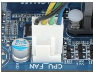
Etape 6 : Pour finir, veuillez connecter le connecteur d'alimentation du dispositif de refroidissement du processeur à l'en-tête du ventilateur du processeur (CPU\_FAN) sur la carte mère.
