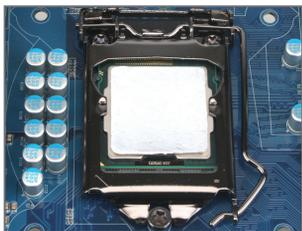
Etape 1 : Appliquez une couche fine homogène de graisse thermique sur la surface du processeur installée.
