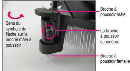
Etape 2 : Avant d'installer le dispositif de refroidissement, notez le sens du symbole de la flèche
