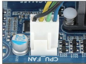
Etape 6 : Pour finir, veuillez connecter le connecteur d'alimentation du dispositif de refroidissement du processeur à l'entête du ventilateur du processeur (CPU\_FAN) sur la carte mère.
