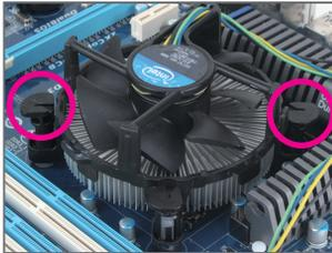
Etape 3 : Placez le dispositif de refroidissement au sommet du processeur, en alignant les quatre broches à poussoir à travers les orifices de broche sur la carte mère. Appuyez vers le bas pour pousser les broches à poussoir diagonalement.
