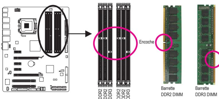
Un module de mémoire DDR2/DDR3 possède une encoche pour être inséré dans un sens uniquement. Suivez les étapes ci-dessous pour installer correctement vos modules de mémoire dans les supports de la mémoire.
