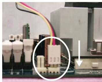
2. Assurez-vous que le ventilateur du CPU est branché au connecteur pour ventilateur du CPU, cela terminera l'installation.
