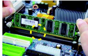
2. Insérez le module de mémoire DIMM verticalement dans le slot DIMM. Ensuite poussez-le vers le bas.
