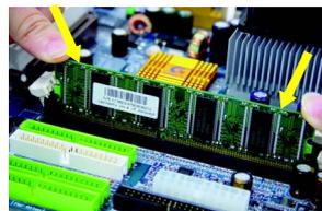
3. Fermez les clips en plastique des deux côtés du slot DIMM pour verrouiller le module DIMM. Inversez les étapes d'installation lorsque vous souhaitez retirer le module DIMM.
