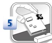
L'ordinateur dispose d'un module wireless LAN, et le module est mis à jour et remplacé par un technicien autorisé ou le centre de service. (Supporté en option).
