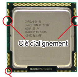
Le triangle jaune est l'indicateur du Pin 1
