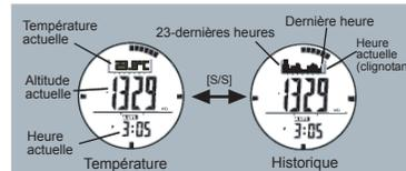
La montre XG-59 permet 2 affichages dans la fonction « Baromètre » : la Température et l'Historique de la pression. A partir de l'affichage principal de l'heure, appuyez brièvement 2 fois sur la touche [Mode] pour entrer dans la fonction « Baromètre ».
