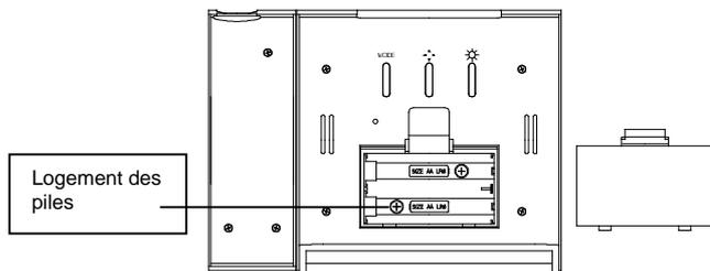
La station météo fonctionne avec 2 piles 1,5V de type IEC LR6 incluses (ou à l'aide d'une alimentation secteur – adaptateur AC/DC joint).
