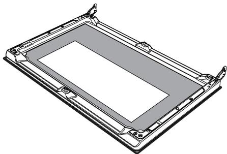
5. Remettez les vitres en place en suivant les opérations de démontage en sens inverse.
