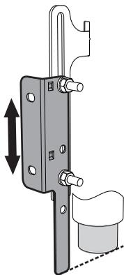
7. Déplacez la bride sur le mur et marquez la position des trous à réaliser dans ce dernier.
