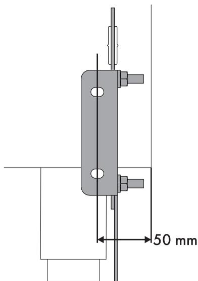
8. Après avoir réalisé les trous dans le mur, utilisez des chevilles avec des vis pour fixer la bride sur ce dernier.
