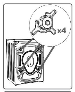
Pour cette raison, les vis de sécurité de transport doivent être desserrées par rotation dans le sens antihoraire à l'aide d'une clé appropriée.
