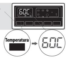
Vous pouvez progressivement diminuer la température de l'eau de lavage entre la température maximale et le lavage à froid (--) en appuyant sur le bouton de réglage de la température de l'eau de lavage.
