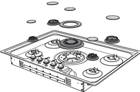
3. Avec une clé à tube de 7 mm dévissez les injecteurs des brûleurs et remplacez-les par des brûleurs compatibles avec le gaz à utiliser (Voir « Tableaux des caractéristiques des brûleurs et injecteurs »).
