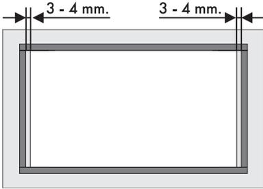
2. Faites-le adhérer, d'une légère pression, sur la surface du périmètre extérieur du trou réalisé dans le plan de travail ; les côtés antérieur et postérieur du joint doivent se trouver au ras du trou.
