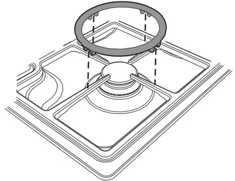
La grille doit être positionnée au-dessus de la grille de la plaque de cuisson d'après la figure suivante.
