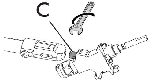
2. Avec une clé fixe, démontez les injecteurs « C » et montez ceux indiqués pour le nouveau type de gaz, en suivant les indications figurant dans les tableaux correspondants (voir « Tableaux des caractéristiques des brûleurs et injecteurs »).
