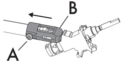
1. Desserrez la vis « A » et poussez à fond le régulateur d'air « B ».
