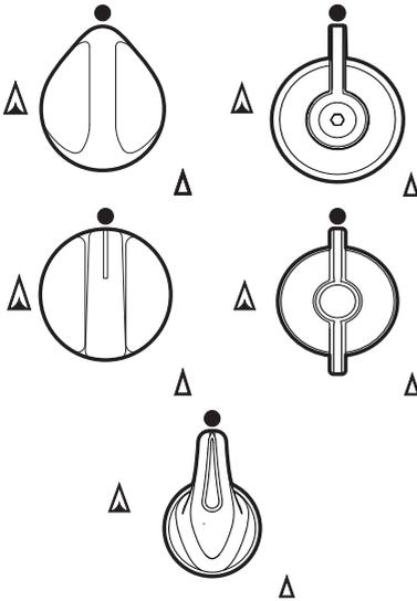
Utiles pour allumer et régler les brûleurs du plan de cuisson. Enfoncez et tournez dans le sens inverse des aiguilles d'une montre sur la valeur
