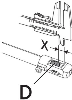
4. Réglez l'arrivée d'air en déplaçant le tube Venturi « **D** », à la distance « **X** » indiquée dans les tableaux correspondants (voir « Tableau des caractéristiques des brûleurs et des injecteurs », au paragraphe « Air primaire (mm) »); ensuite, serrez la vis « **A** ».
