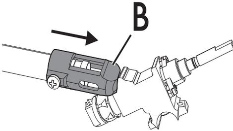
3. Remplacez le support « **B** » dans sa position initiale de manière à couvrir complètement l'injecteur « **C** ».
