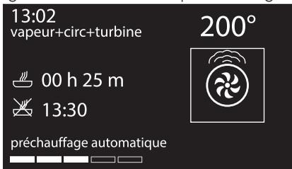
À la fin du préchauffage la température arrive au niveau maximum réglé.
