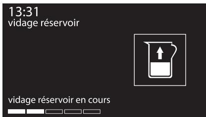
L'eau résiduelle est vidée dans le bac d'évaporation : cela en facilite l'élimination et contribue à refroidir rapidement la cavité de cuisson.
