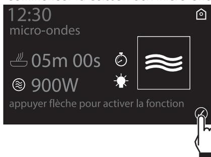
11. Sur l'afficheur apparaît la fonction choisie, la puissance sélectionnée, l'heure actuelle et le temps restant avant la fin de la fonction.
