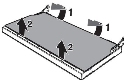
6. Remettez les vitres en place en suivant les opérations de démontage en sens inverse.
