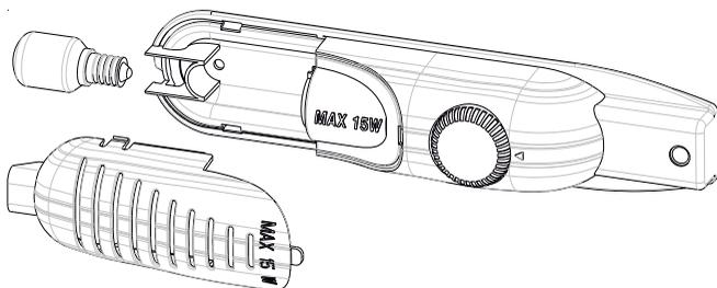
**Lorsque l'on remplace la lampe du réfrigérateur ;**
