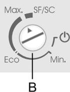
Pour mettre l'appareil en marche, tournez le bouton du thermostat (B) vers la position **Max** ; pour le mettre à l'arrêt, positionnez le curseur en face de l'icône Marche/Arrêt
