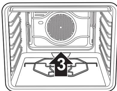
Remplacez la sole d'appui de la plaque à pizza, en la poussant contre le panneau de fond du four et abaissez-la de manière à ce que la plaquette de la résistance s'encastre dans la base.
