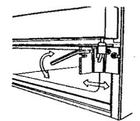
4) Desserrer les vis au milieu. Monter la porte inférieure et après la charnière au milieu.
