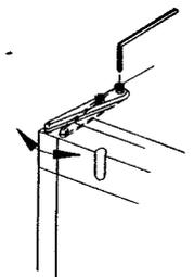
3) Montez la cache-socle et montez les caches-bouchons sur le côté opposé.
