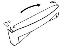
6) Ajustage de la porte inférieure: Desserrez les 3 vis dans la charnière inférieure et la réglez de côté. Serrez les vis et montez la cache-socle.
