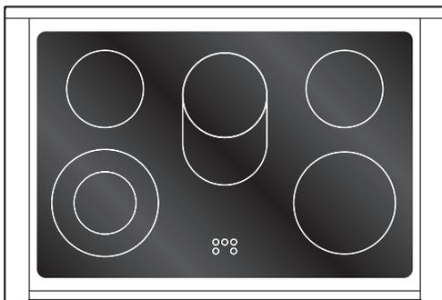
L'appareil est équipé de 5 zones de cuisson ayant des diamètres et des puissances différents. Leur position est clairement indiquée par des cercles et la chaleur est délimitée à l'intérieur des diamètres tracés sur la surface en vitrocéramique. Les 5 zones de cuisson sont du type HIGH-LIGHT et s'allument quelques secondes après
