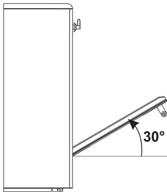
Pour remonter la porte, introduisez les charnières dans les fentes prévues à cet effet sur le four en s'assurant que les rainures **C** sont complètement posées contre les fentes. Abaissez la porte puis, après l'avoir positionnée, sortez les pivots des trous des charnières.
