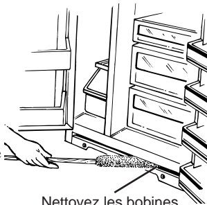
Nettoyez les bobines du condenseur au moins une fois par an
