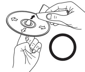
Essayez délicatement le disque par des mouvements rectilignes allant du centre au bord.
