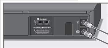
1 Branchez le câble de l'antenne se trouvant sur le toit dans la prise d'antenne »T« du magnétoscope.
