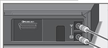
**1** Raccordez le câble d'antenne de l'antenne domestique à la prise d'antenne «
