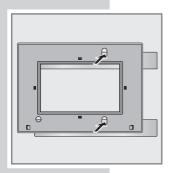
2 Retirez les barres frontales du cadre en appuyant – le cas échéant avec un objet approprié – à travers l'ouverture correspondante.
