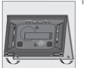
1 Retirez le cadre frontal en repoussant les deux verrous »LOCK« situés au dos de l'appareil vers la gauche et vers la droite et en poussant le cadre vers l'avant.
