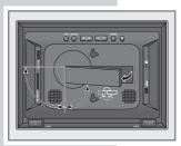
1 Sortez le pied support du renfoncement au dos du cadre photo numérique et tournez-le dans le sens des aiguilles d'une montre jusqu'à ce qu'il s'enclenche dans la position souhaitée.
