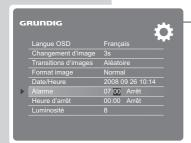
Si elle est programmée, l'alarme s'active pendant le fonctionnement ou en mode veille (stand-by). Le signal sonore de l'alarme retentit à l'heure programmée.
