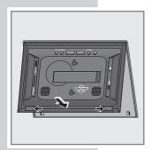
4 Emboîtez le bord inférieur du cadre photo dans le cadre frontal et poussez les deux verrous »LOCK« situés au dos de l'appareil vers la gauche et vers la droite.
