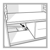
De koelkast is voorzien van een automatische ontdooifunctie: het water wordt door een speciale afvoeropening (zie afbeelding) naar de achterkant geleid waar de warmte van de compressor het doet verdampen. Het enige wat u af en toe moet
