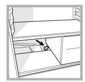
Le réfrigérateur est muni d'un système de dégivrage automatique : l'eau est acheminée vers la paroi arrière par un trou d'évacuation (*voir figure*) où la chaleur produite par le compresseur la fait évaporer. Il vous suffit de nettoyer périodiquement le trou d'évacuation pour
