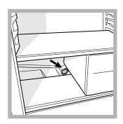
Il frigorifero è dotato di sbrinamento automatico: l'acqua viene convogliata verso la parte posteriore da un apposito foro di scarico (*vedi figura*) dove il calore prodotto dal compressore la fa evaporare.
