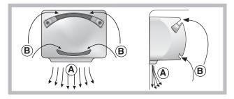
Wind Pure System ottimizza al massimo la circolazione dell'aria, migliorando l'efficacia dell'evaporatore e contribuendo a raggiungere più rapidamente la giusta temperatura all'interno del frigo dopo ogni apertura. L'aria soffiata (A) si raffredda a contatto della parete fredda, mentre l'aria più calda (B) viene aspirata (*vedi figura*).
