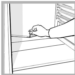
Il frigorifero è dotato di sbrinatorio automatico: l'acqua viene convogliata verso la parte posteriore da un apposito foro di scarico (*vedi figura*) dove il calore prodotto dal compressore la fa evaporare. L'unico intervento da fare periodicamente consiste
