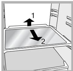
**DRAAGPLATEAUS:** plateaus of roosters. Deze kunnen dankzij de speciale gleuven worden verwijderd of in hoogte geregeld (*zie afbeelding*), voor het invoeren van grote verpakkingen of etenswaren. Het is niet noodzakelijk het draagplateau
