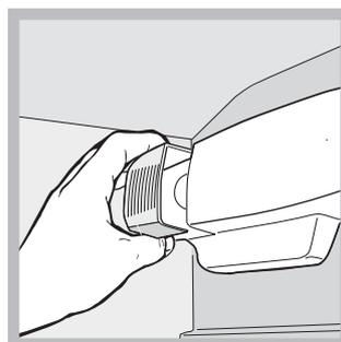
Pour pouvoir remplacer l'ampoule, démontez le couvercle de protection comme illustré (*voir figure*). Remplacez-la par une ampoule semblable dont la puissance doit correspondre à celle indiquée sur le couvercle de protection (10 W ou 15 W).
