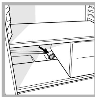
De koelkast is voorzien van een automatische ontdooifunctie: het water wordt door een speciale afvoeropening (zie afbeelding) naar de achterkant geleid waar de warmte van de compressor het doet verdampen. Het enige wat u af en toe moet doen is de opening reinigen en controleren of het water vrijuit kan afvloeien.
