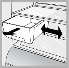
Bac **MULTIFONCTION:** pour conserver plus longtemps certains aliments (la charcuterie par exemple) et éviter la diffusion d'odeurs à l'intérieur du réfrigérateur. A extraire pour utilisation, il peut être déplacé latéralement pour optimiser la place disponible (*voir figure*).
