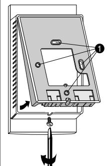
Pour cela, desserrez la vis de verrouillage comme indiqué ci-contre. Ainsi séparé du boîtier, le socle doit être fixé au mur à l'aide d'un ensemble vis/chevilles ou sur boîte d'encastrement (entraxe 60mm) en utilisant les trous repérés ①.
