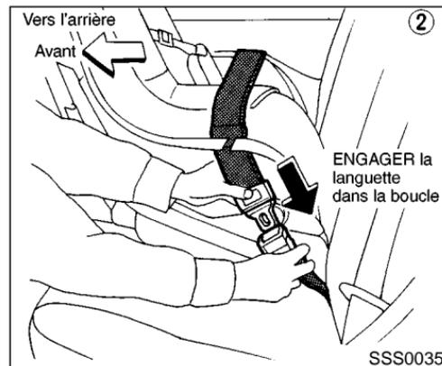
2. Faites passer la languette de la ceinture de sécurité à travers le dispositif de retenue pour enfant et introduisez-le dans la boucle jusqu'à ce que vous entendiez ou sentiez le déclic. Suivez les instructions du fabricant du dispositif de retenue pour enfant.
