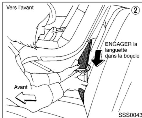
2. Faites passer la languette de la ceinture de sécurité à travers le dispositif de retenue pour enfant et introduisez-la dans la boucle jusqu'à ce que vous entendiez ou sentiez le déclic. Suivez les instructions du fabricant du dispositif de retenue pour enfant.
