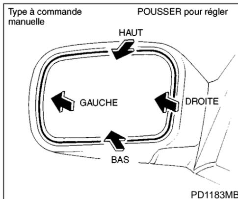
L'orientation des rétroviseurs extérieurs des portières peut être effectuée à volonté afin que la visibilité arrière soit optimale.
