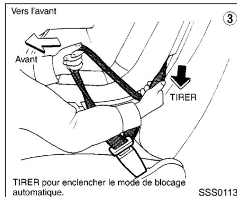
3. Tirez sur la ceinture thoracique jusqu'à ce que la ceinture soit complètement sortie. L'enrouleur automatique passera en mode de blocage automatique (mode de siège de retenue pour enfant). Il revient en mode de blocage d'urgence lorsque la ceinture est complètement rétractée.
