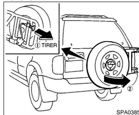
Pour ouvrir le hayon, commencez par ouvrir le support de roue de secours dans l'ordre indiqué par l'illustration ci-dessus puis introduisez la butée dans l'orifice afin d'immobiliser le support en position ouverte.
