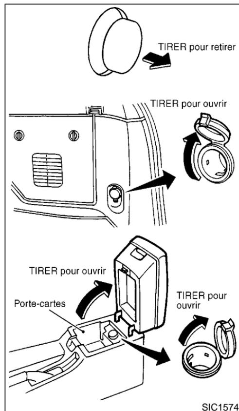
La prise électrique sert à brancher le téléphone cellulaire et autres accessoires électriques.
