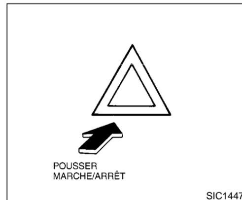
Appuyez sur ce commutateur pour avertir les autres usagers de la route lorsque le véhicule doit être immobilisé en cas d'urgence. Tous les clignotants fonctionnent simultanément.
