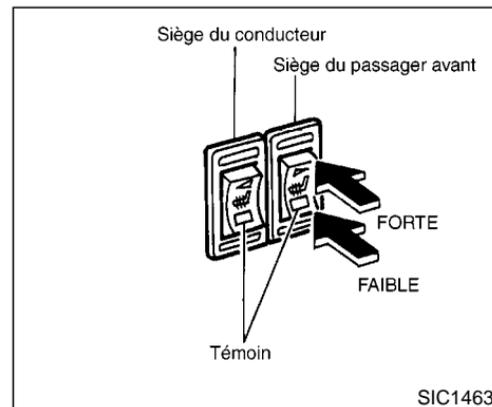
Le(s) siège(s) avant sont chauffés grâce au dispositif de chauffage incorporés. Les commutateurs sont installés sur le tableau de bord et peuvent être commandés individuellement l'un de l'autre.
