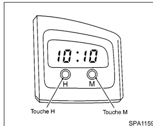
La montre électronique affiche l'heure lorsque le contacteur d'allumage est en position ACC ou ON.
