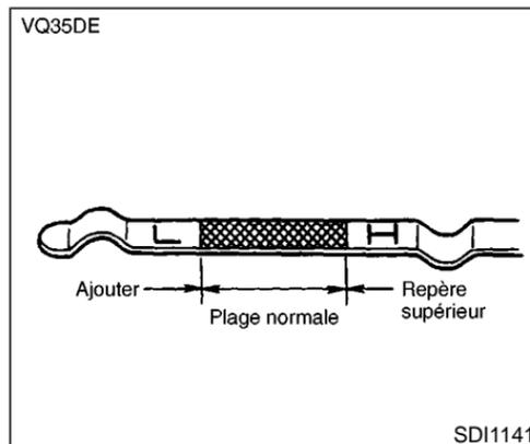
5. Retirez de nouveau la jauge et vérifiez le niveau d'huile qui doit arriver entre les deux repères (H et L). Si le niveau d'huile est au-dessous du repère L, enlevez le bouchon de remplissage d'huile et rétablissez le niveau avec l'huile recommandée. Ne remplissez pas trop.
