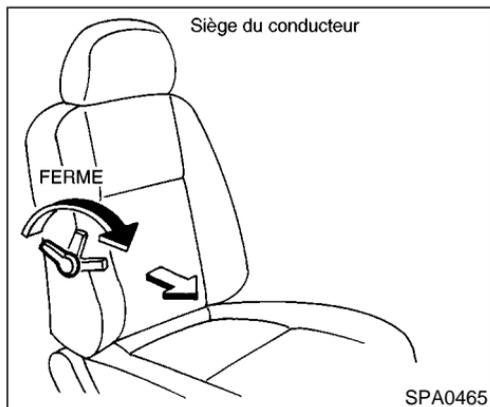
Support lombaire (si le véhicule en est équipé sur le siège du conducteur)
