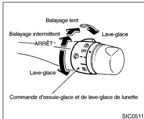
L'essuie-glace et le lave-glace arrière fonctionnent lorsque le contacteur d'allumage est sur ACC ou ON.
