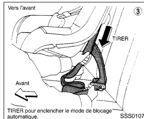
3. Tirez sur la ceinture thoracique jusqu'à ce que la ceinture soit complètement sortie. L'enrouleur automatique passera en mode de blocage automatique (mode de siège de retenue pour enfant). Il revient en mode de blocage d'urgence lorsque vous ouvrez la boucle et que la ceinture est complètement rétractée.
