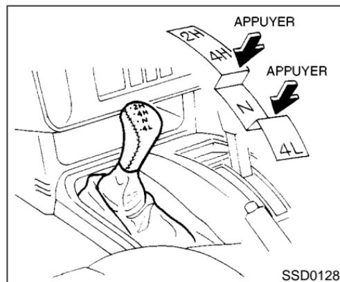
**2H** — (2WD, Haut régime) L'entraînement ne se fait qu'aux roues arrière. Positionnez sur ce cran pour utiliser le véhicule comme un véhicule classique avec entraînement aux deux roues.
