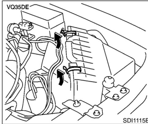
L'élément filtrant ne doit pas être nettoyé ni réutilisé car il a reçu un traitement spécial. Il est recommandé de le remplacer aux intervalles. Veuillez vous reporter à la rubrique « Programmes d'entretien périodique » dans le livret d'entretien fourni séparément. Lors du remplacement de l'élément filtrant, nettoyez l'intérieur du boîtier et du couvercle du filtre avec un chiffon humide.
