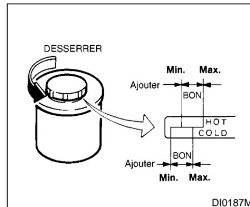
Vérifiez le niveau du liquide du réservoir de direction assistée. La graduation HOT sera prise pour une vérification à chaud de l'huile à 50 à 80°C (122 à 176°F) et la graduation COLD sera prise pour une vérification à froid de l'huile à 0 à 30°C (32 à 86°F).
