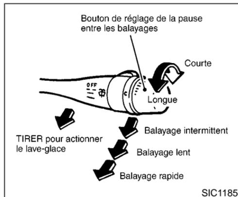
Les essuie-glaces et le lave-glace fonctionnent lorsque la clé de contact est sur ACC ou sur ON.
