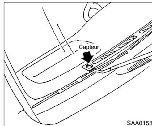
Le capteur qui se trouve sur le tableau de bord aide à maintenir une température constante. Ne posez rien sur ou près du capteur.
