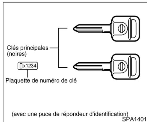
Le véhicule ne peut être mis en marche qu'avec les clés principales enregistrées pour le système antidémarrage du véhicule NISSAN. La tête de ces clés contient une puce de répondeur d'identification.
