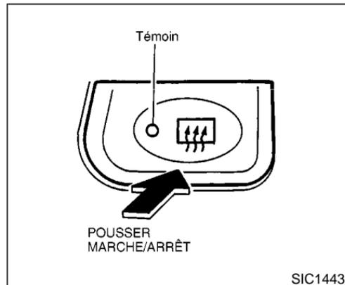
Pour dégivrer le hayon vitré et les rétroviseurs extérieurs, démarrez le moteur et appuyez sur le commutateur (le témoin doit s'allumer). Appuyez de nouveau sur le commutateur pour arrêter le dégivreur.
