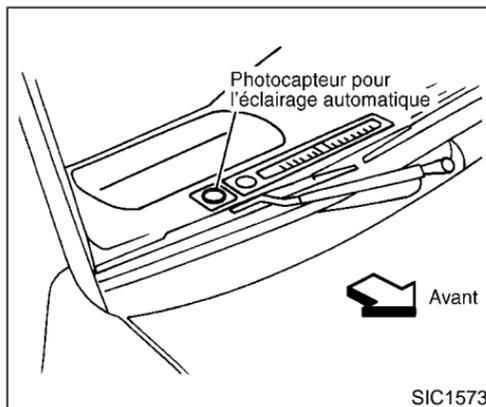
**Ne couvrez pas le photocapteur qui se trouve en haut et à droite du tableau de bord. Le photocapteur commande l'éclairage automatique. S'il est couvert, il réagira comme s'il faisait noir et les phares s'allumeront.**
