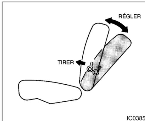
Réglage de l'inclinaison (si le véhicule en est équipé)
