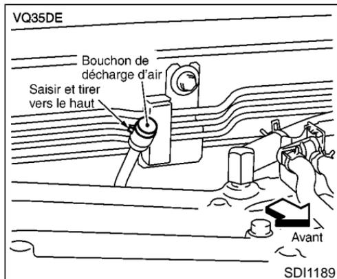
3. Ouvrez le bouchon de décharge d'air pour vidanger le liquide de refroidissement.
