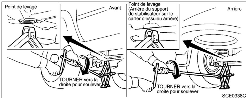
Levage du véhicule et dépose du pneu abîmé
