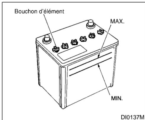
Vérifiez le niveau d'électrolyte dans chaque élément. Le niveau doit arriver entre les repères MAX et MIN.
