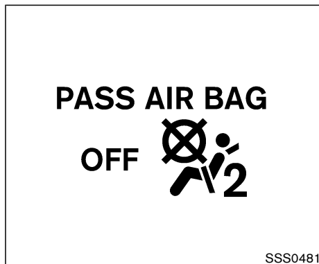
Indicateur du statut du coussin gonflable côté passager avant Indicateur de statut et coussin gonflable côté passager avant
