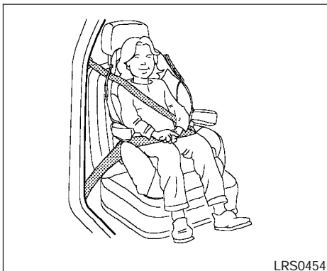
Installation d'un rehausseur sur le siège du passager avant
